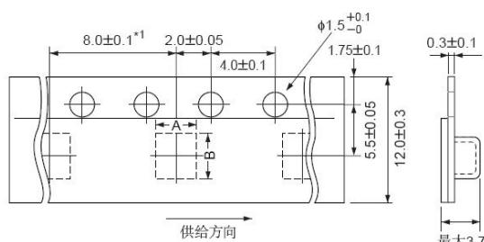
A: 1.45±0.20 B: 2.25±0.20 (0805) A: 1.95±0.20 B: 3.50±0.20 (1206) (单位 unit:毫米 mm)
