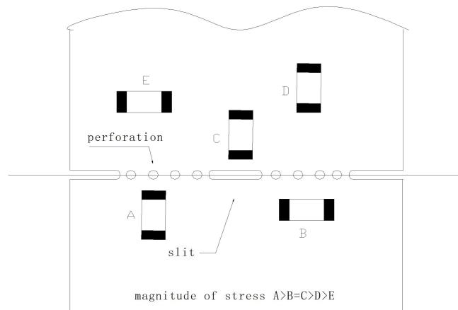
在沿着分拨线分拨电路板时，对产品施加的机械应力与使用的方法关系很大。分折电路板时片状元件受到的疲劳按照如下顺序增大：分折、剪切、V型槽、穿孔。因此，贴装时应该考虑电路板的分拨过程。
